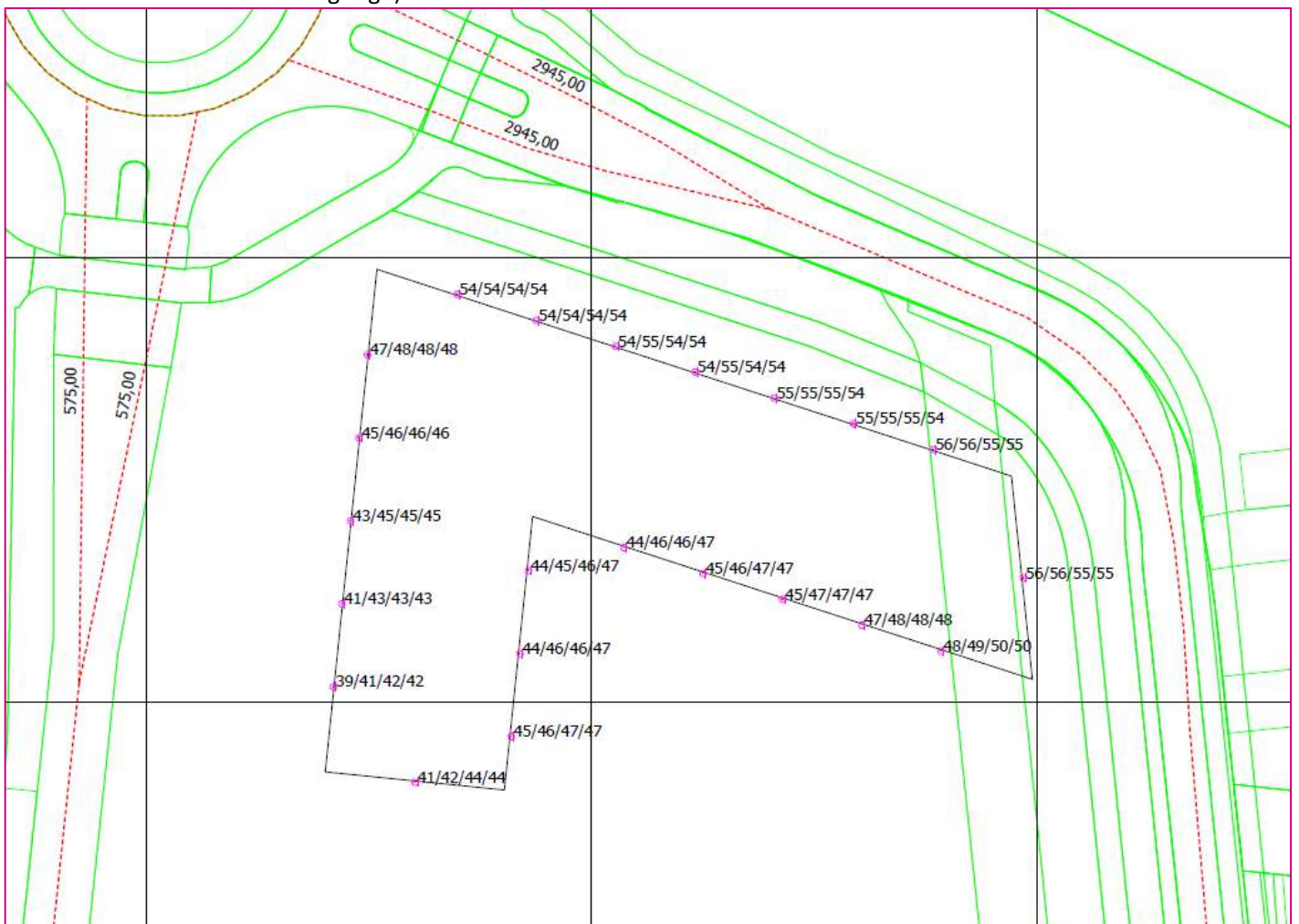
Figuur 5.1: overzicht van de berekende geluidbelasting L_{den} in dB vanwege de Beursstraat (inclusief 5 dB aftrek op basis van artikel 110g Wgh)
