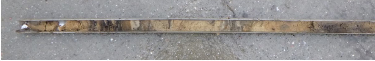
Figuur 7: Het pakket rommelig zand (midden) op door laagjes detritusveen onderbroken dekzand (links van het midden).
