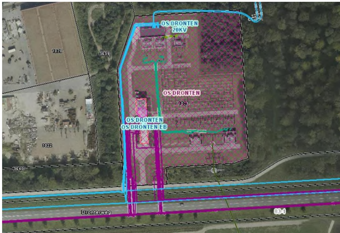
afbeelding 8: Ontsluiting Onderstation Dronten op 20kV distributienet (bron: Reddyn)
