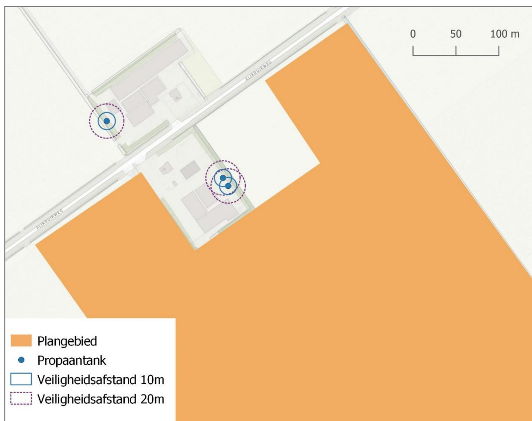
Figuur 3. Veiligheidsafstanden propaantanks
