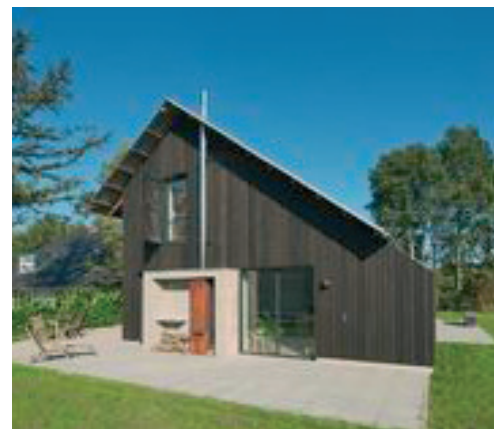
assymetrische kap met lage en hoge goot
