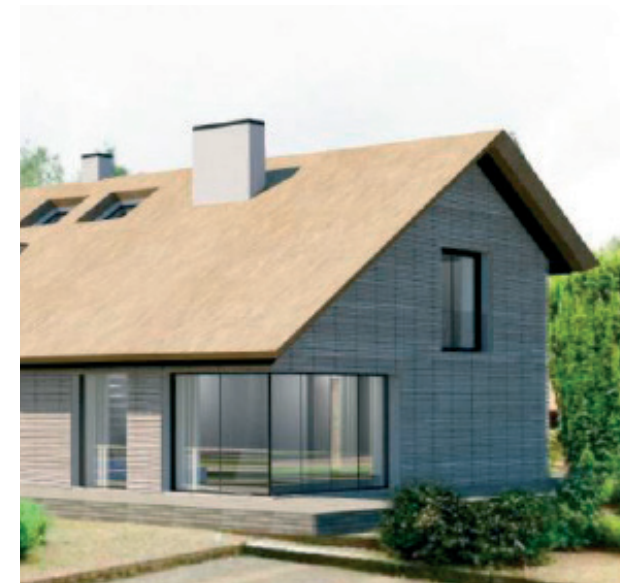
assymetrische kap met lage en hoge goot en duidelijke dakrand
