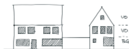
horizontale geleding van de gevel, verdieppingsafhankelijke raamverdeling
