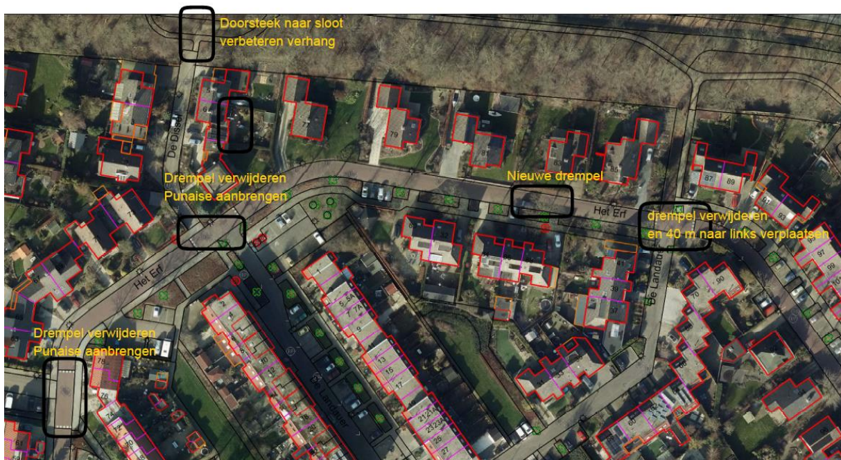
Figuur: maatregelen tegen wateroverlast in en rond Het Erf
